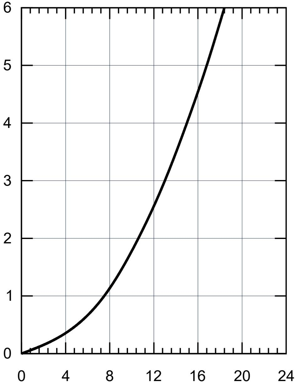
— Druckverlustkurve mit nachgeschaltetem geräuscharmen Widerstand der Durchflussklasse A (0.25 l/s bei 3 bar Fließdruck).
