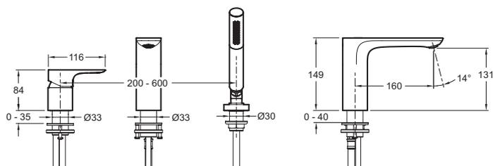
Kurzbeschreibung: 3-Loch Wannenmischer. E72292. Kollektion: ALEO. GEWICHT: 6,6 kg. MATERIAL: Messing. INSTALLATIONSART: 3-Loch. ART: Armatur. DURCHFLUSSMENGE: 22 l/min, Handdusche 9,5 l/min.. BETÄTIGUNGSMECHANISMUS: Keramik-Kartusche.
