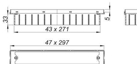
zum Einbau mit Ablaufgehäusen CeraFlex, CeraFlex Plan, CeraFlex senkrecht, DallFlex, DallFlex Plan, DallFlex senkrecht und Duschelementen DallFlex Compact, DallFlex Compact Plan.
